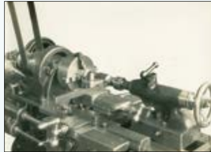
Drehbank mit rotierender BRUCKNER Hochleistungsspitze
