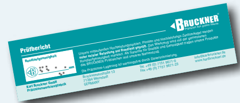
Prüftabelle „Rundlaufgenauigkeit“ am Beispiel Typ ZA, ZAG
